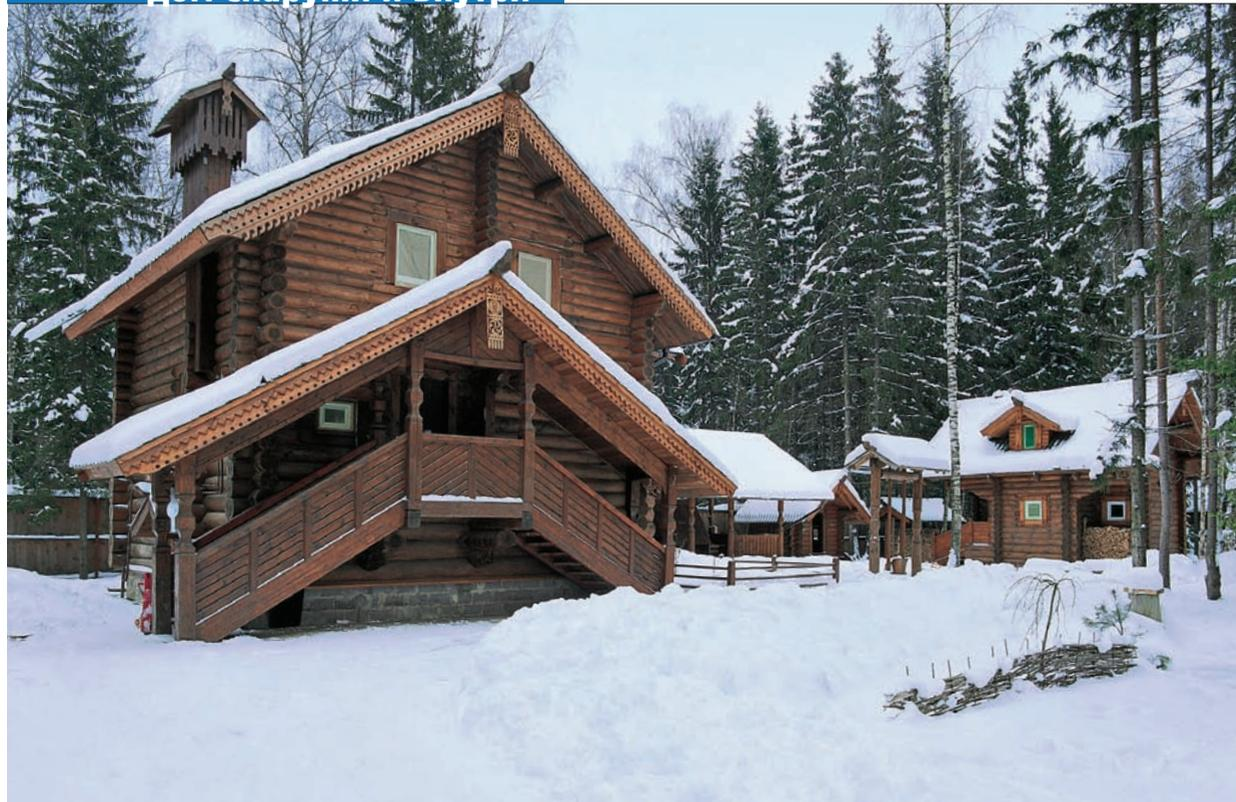
➔ Высокое архангельское крыльцо с двумя спусками— и функциональная, и декоративная деталь дома. Цоколь, сложенный из строительных блоков, не позволяет брёвнам сруба соприкасаться с землёй, что снижает риск поражения дерева гнилью. Вытяжная труба одета в резной деревянный кожух, называемый дымником
